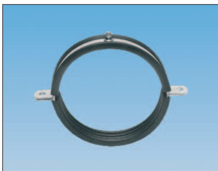
Rohrschellen zweiteilig, aus verzinktem Stahlblech mit Gummieinlage, 25 x 2 mm, mit Gewindebuchse M8.
