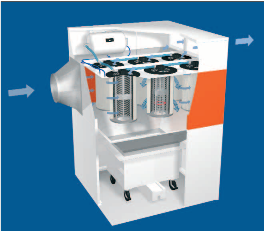
Schnittzeichnung eines Filterteils aus dem System 9000
