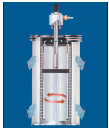
Bei der Tiefenfiltration dringen die Schadstoffe in das Filtermaterial ein. Eine Abreinigung ist praktisch nicht möglich.
