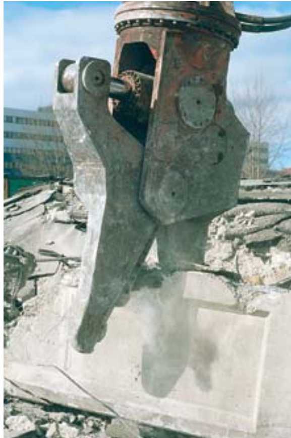
Die Härte und Verschleißfestigkeit von HARDOX-Blech spielt bei dieser Art von Produkt eine entscheidende Rolle, da große Teile der Konstruktion extremer Beanspruchung ausgesetzt werden.
