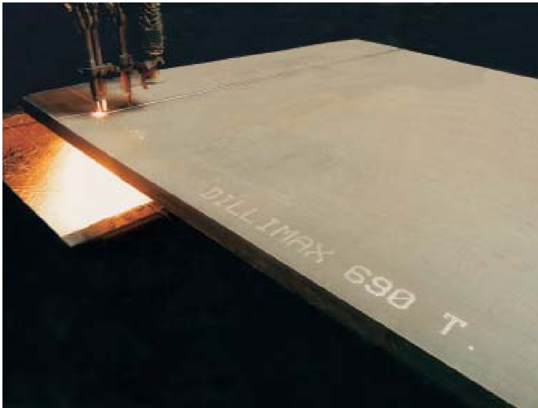
Bild 10: Autogenes Brennschneiden eines DILLIMAX 690 T
